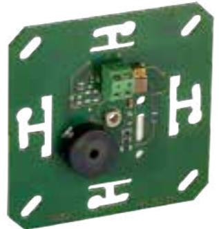
Модуль может быть установлен как в отдельном корпусе, так и в корпусе, имеющемся на месте эксплуатации. Компоненты совместимы со многими европейскими корпусами для электропреключателей (например, Jung, Gira, Merten, Feller). Для Siedle мы предлагаем индивидуальные варианты монтажа.
