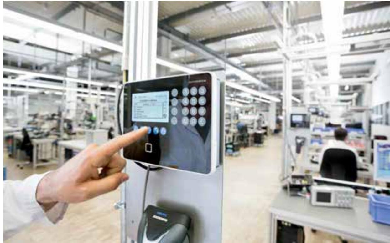
Терминал В-есо предлагает удобное для пользователя решение с идентификацией посредством RFID-карты или биометрического отпечатка пальцев для всех задач по сбору данных и сбора рабочих данных с помощью считывателя штрих-кодов на ПЗС
