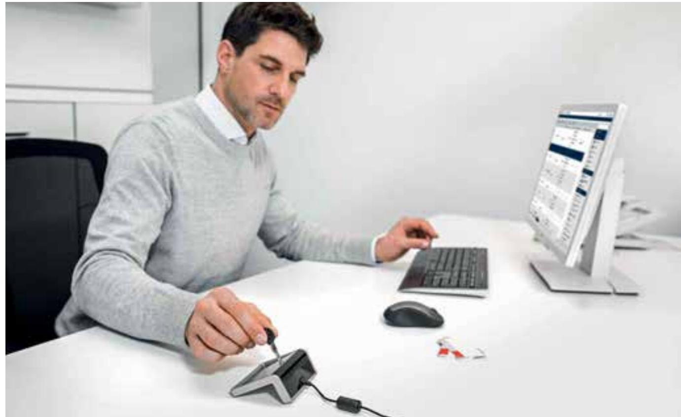
Настольный считыватель dormakaba 9108 читает и записывает RFID-носители в виде карт, смарт-ключей или брелоков, которые используются для идентификации в СКУД и УРВ. Настольный считыватель подключается к ПК через USB-порт. Устройство автоматически обнаруживается и настраивается в ПО Windows.
