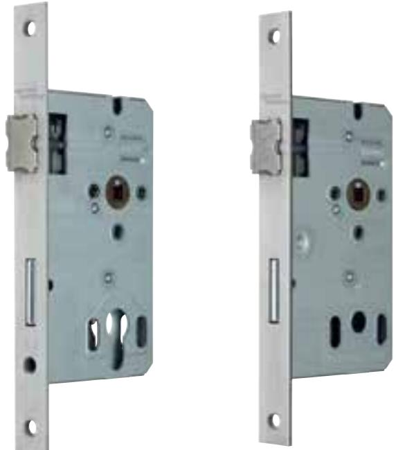
Модели серии 170 – надежные дверные замки с продолжительным сроком службы. Замки данной серии сертифицированы в соответствии с нормой DIN 18251 класс 2. Защелка с фиксатором может закрываться как с правой, так и с левой стороны. Корпус и крышка замка изготовлены из оцинкованной листовой стали толщиной 1 мм
