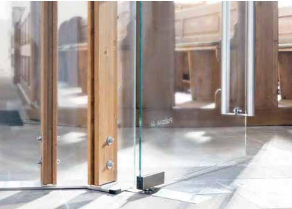
Напольный доводчик специально для маятниковых дверей. Благодаря низкой глубине всего 40 мм, для модернизации достаточно углублений в плоском полу.
