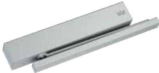
Дверные доводчики с функцией свободного хода обеспечивают практически свободный проход через противопожарные двери. Благодаря функции свободного хода двери распахиваются свободно, что особенно удобно для безбарьерной конструкции согласно DIN 18040 или DIN SPEC 1104, а также в аварийных ситуациях, однако, только в сочетании с панелью детектора дыма.
