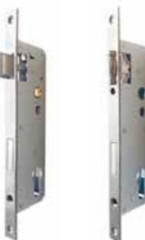
Бюджетная линейка узкопрофильных замков с защёлкой-ригелем и с роликом-ригелем для дверей из ПВХ и алюминиевого профиля. Закрытый корпус защищает механизм замка от попадания стружки и пыли, продлевая ресурс работы замка. Ролик замка и втулка под шток ручки изготовлены из латуни.
